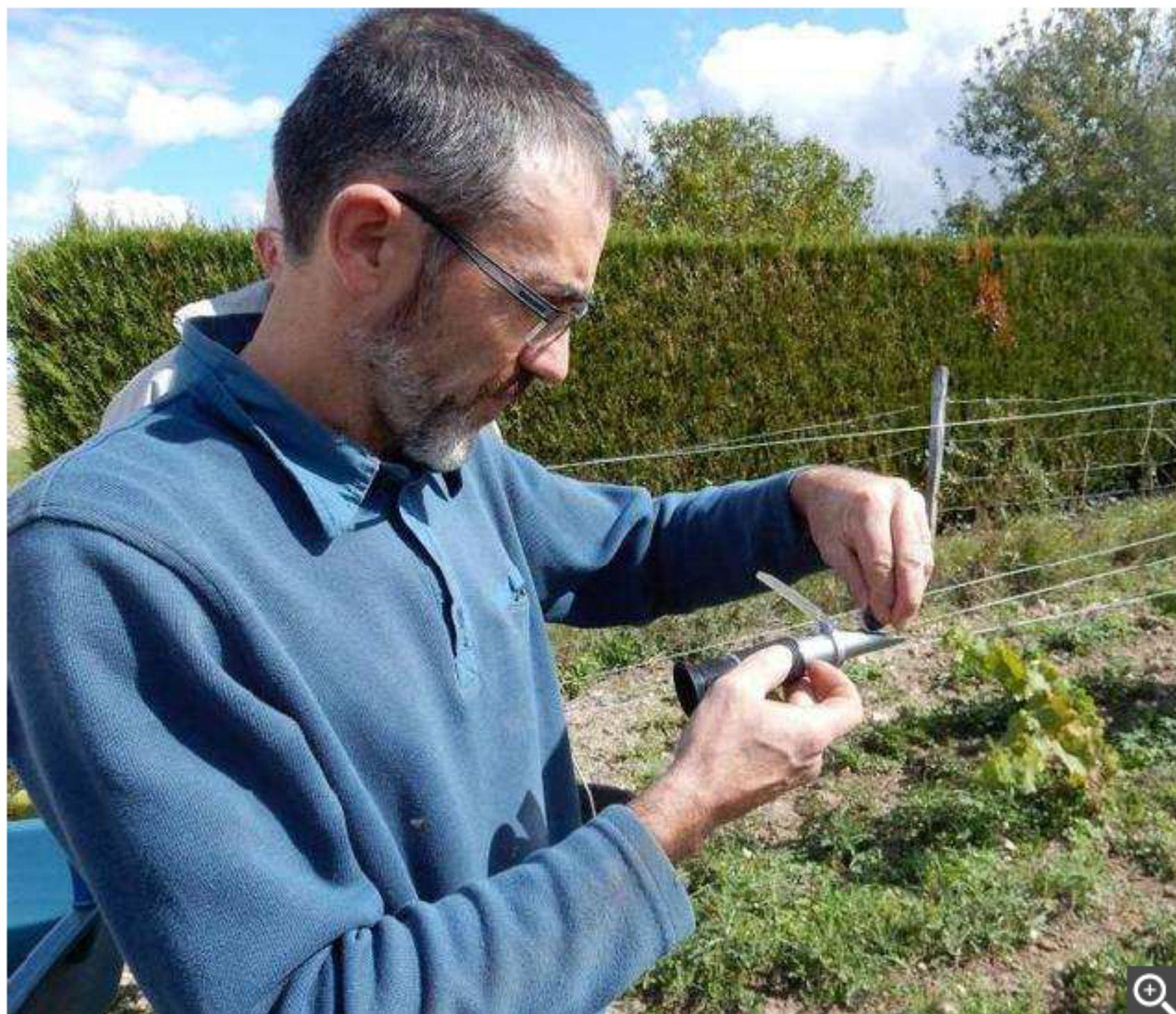
Le réfractomètre indique 11 degrés.
